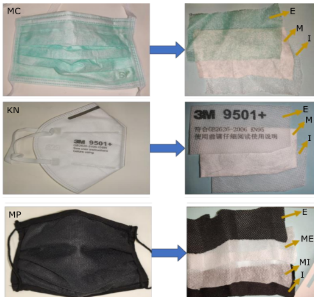
Figura 1.4 Imagens de três tipos de DPRs. Topo: máscaras cirúrgicas (MC); Centro: máscaras KN95 (KN); e Base: máscaras de pano (MP). Camadas constituintes dos DPRs: camada externa (E), camada interna (I'), e camada intermédia (M). No caso das máscaras tipo MP, as camadas intermédias foram indicadas como camada intermédia próxima à camada externa (ME) e camada intermédia próxima à camada interna (MI).
