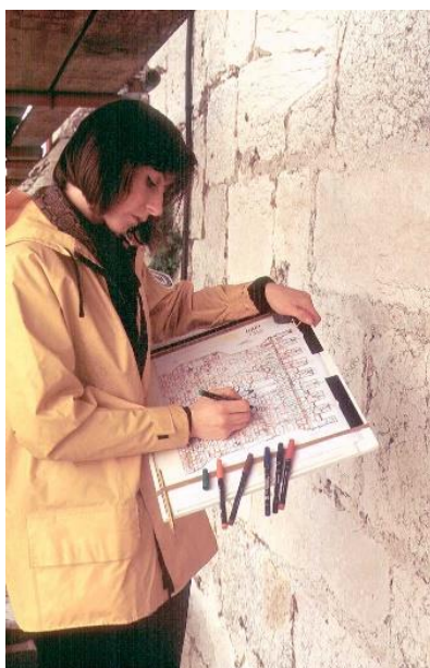
Figura 3-2 - Fase de inspeção e levantamento de patologias. (Fonte: https://www.ncretauro.pt )
