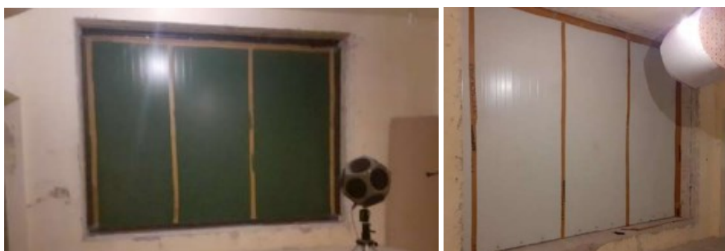
Figuras 26 e 27- Painel sanduíche de revestimento (P1) com aplicação das bandas de reforço - Vista de ambas as faces
