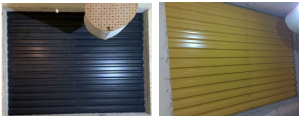
Figuras 32 e 33- Sistema de revestimento duplo (P3) - Vista de ambas as faces
