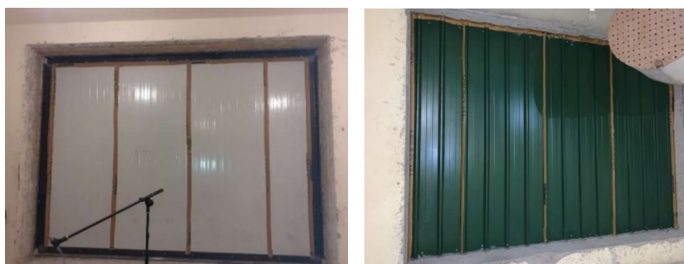
Figuras 30 e 31- Painel sanduíche para coberturas inclinadas (P2) com aplicação das bandas de reforço - Vista de ambas as faces
