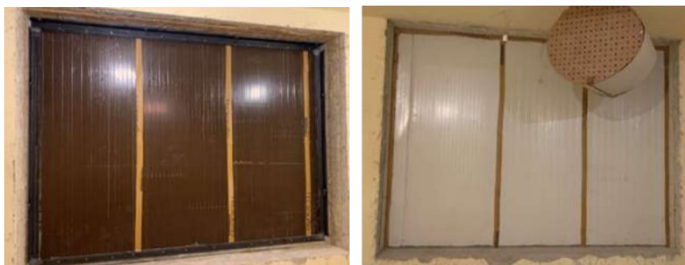
Figuras 35 e 36- Painel sanduíche para coberturas planas (P4) com aplicação das bandas de reforço - Vista de ambas as faces
