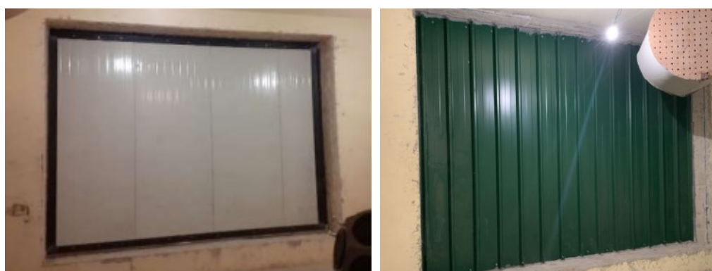
Figuras 28 e 29- Painel sanduíche para coberturas inclinadas (P2) - Vista de ambas as faces
