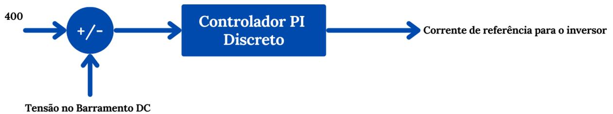
Figura 2.16: Esquemático controlador PI Discreto do Barramento DC
