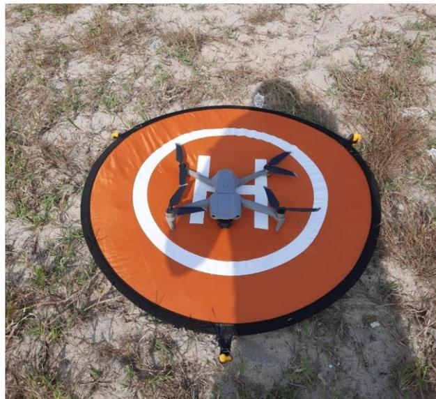
**Figura 6** - O Drone *Dji Mavic Air 2* utilizado na aquisição de um mosaico de fotografias aéreas que serviram para auxiliar e complementar as observações de campo na elaboração da cartografia geomorfológica nas três áreas-amostra anteriormente delimitadas. O aparelho tem uma dimensão de cerca de 30 cm na sua diagonal e 570 g de peso.
