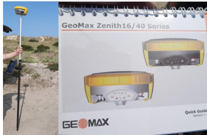
**Figura 5** - GPS portátil, com correção diferencial através da ligação à rede local ReNEP - *Geomax Zenith* GNSS 16/40 - utilizado no terreno para o levantamento de precisão dos perfis topográficos transversais ao sistema praia-duna nas três áreas-amostra previamente selecionadas para a Praia da Tocha.
