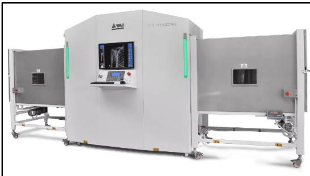
Figura 10 – Sistema para radiografia digital – X FLATSCAN DF-80. Fonte: VMI Security.
