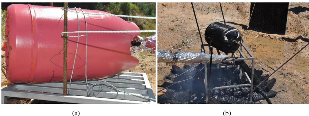
Figura 5.1: Teste T1CB; (a) garrafa compósita antes do teste; (b) garrafa compósita após o teste.
