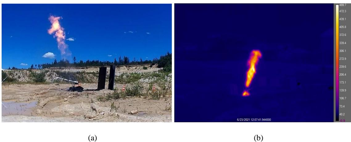
Figura 5.5: Imagem do Jato de fogo do teste T2SP; (a) câmara visível; (b) câmara IR.
