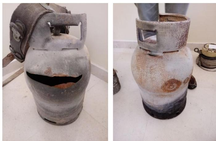
Figura 1.2: Garrafas metálicas com volume expandido após aquecimento e zona de rotura no topo da garrafa.
