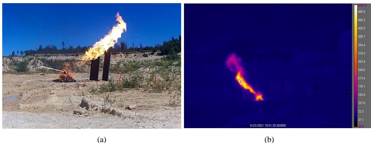
Figura 5.3: Imagem do jato de fogo do teste T1CB; (a) câmara visível; (b) câmara IR
