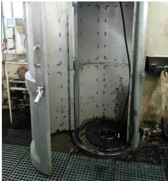
Figura 4.1: Câmara de testes usada para os testes de rotura das garrafas sob pressão hidrostática.
