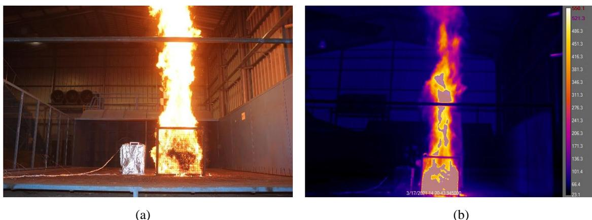
Figura 5.32: Fotografias do teste laboratorial com a proteção composta pela manta ignífuga; (a) CAM UV; (b) CAM IR.
