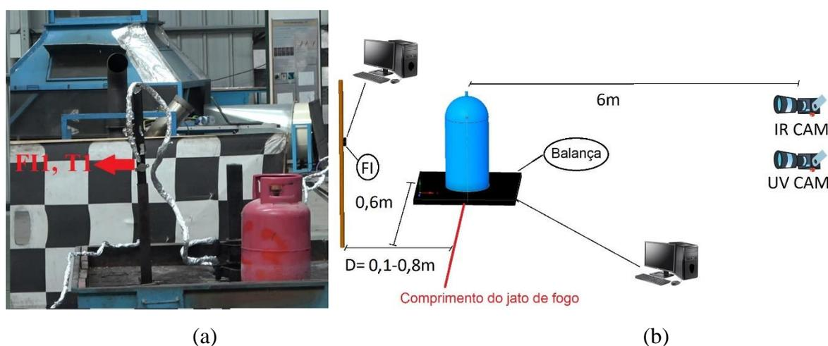
Figura 4.16: Imagens dos testes laboratoriais do jato de fogo; (a) fotografia do teste; (b) desenho esquemático do aparato experimental.
