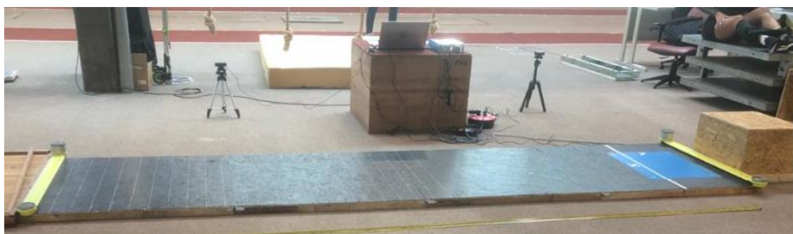
Figura 12: Plataforma de madeira desenhada e construída para este estudo. A gradação da distância foi feita em milímetros
