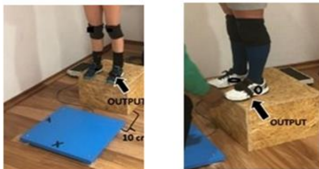
Figura 4. Exemplo de localização da IMU no pé do atleta.
