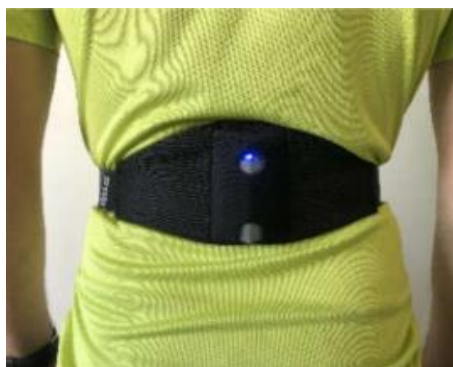
Figura 3. Exemplo de localização do cinto com fita adesiva de dupla face entre L3 e L4 incorporando o acelerómetro Push Band 2.0.
