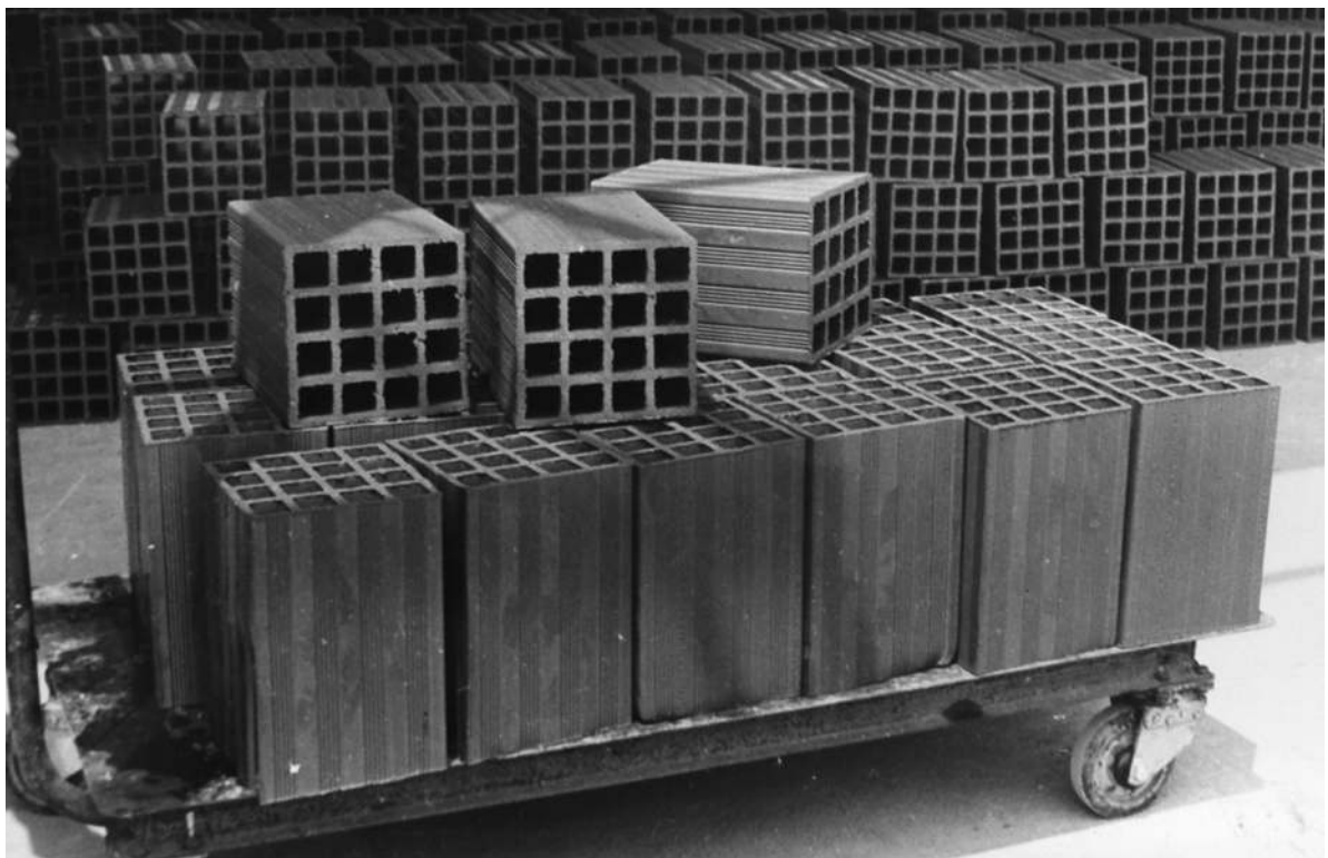
Cerâmica do Luzamba (Cuango). Condução de tijolos vazados (30x20x20), moldagem, secagem [Relatório da DSOVC, 1967. UC/AD]
