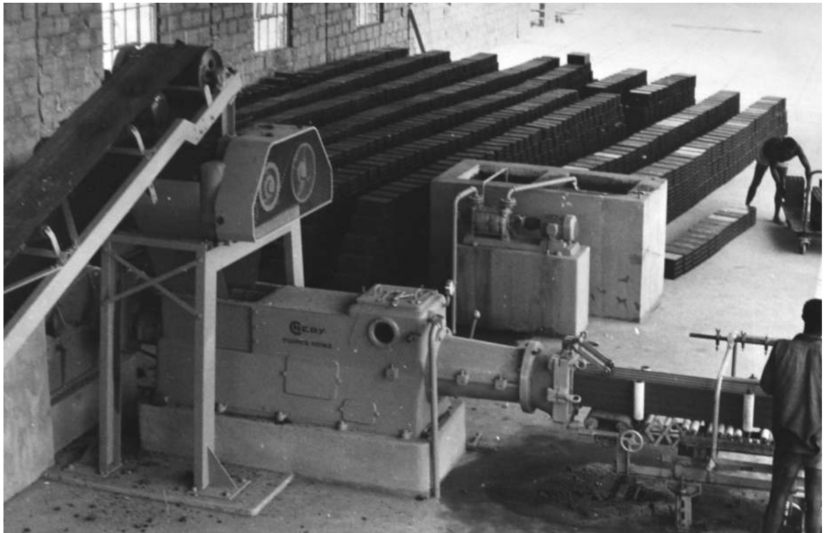
Cerâmica do Luzamba (Cuango). Transportadora, laminador, feira de vácuo e mesa de corte [Relatório da DSOVC, 1967. UC/AD]
