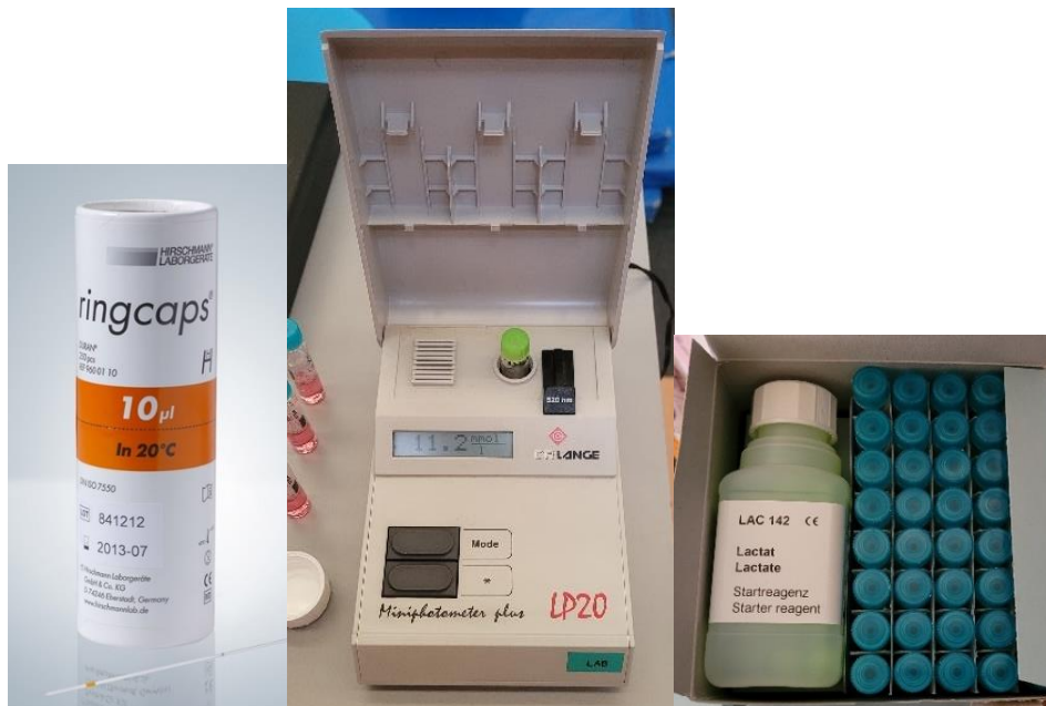
Figuras 13 (a / b / c): Capilares Ringcaps, Mini Espectrofotômetro Plus LP 20 Dr Lange e Reagentes Lactate LAC142
