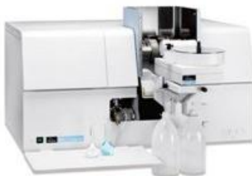
Figura 2 – Espectrofotômetro de absorção atômica (Marca Perkin Elmer e Modelo AAnalyst 800) 50
