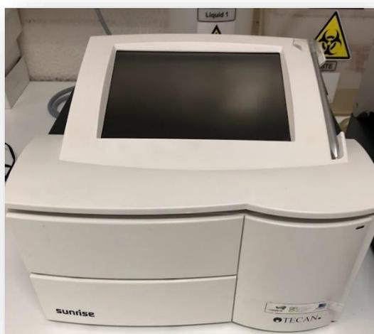
Figura 8| **Leitor de microplacas** com a capacidade de fazer leituras a um valor de absorbância de 550 nm de comprimento de onda.
