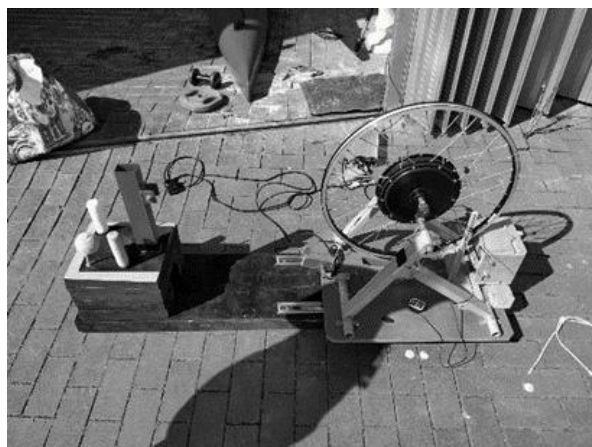
Figura 6 - Imagem do sistema de medição de arrasto passivo.
