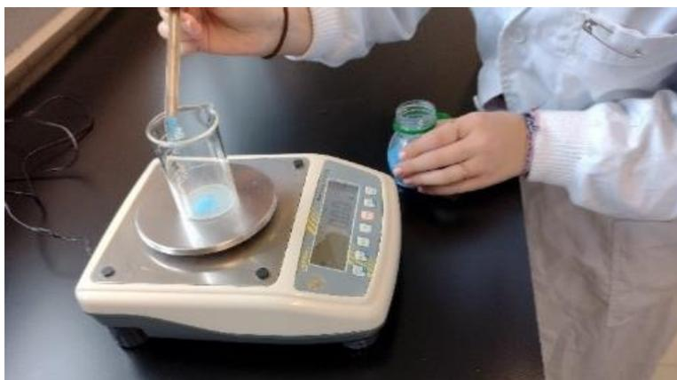
**Figura 12** – Pesagem de sulfato de cobre (II) penta-hidratado (AL 4 “*Soluções a partir de solutos sólidos*”
