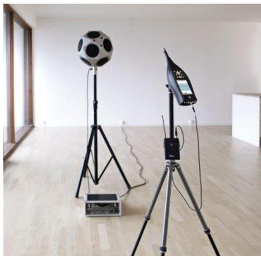
**Figura 3-1** - Fonte Dodecaédrica omnidirecional Tipo 4292 da Brüel &Kjaer / **Figura 3-2** - Conjunto medição acústica composto por Fonte Omnidirecional, amplificador, transmissor e sonómetro.
