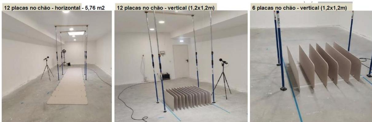
**Figura 4-1** - colocação do provete na horizontal, na vertical, 12 elementos e 6 elementos
