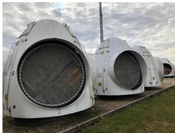
Figura 2.4 - Fotografia de um hub da Martifer Renewable & Energy.
