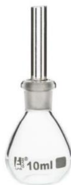
Figura 3.7. Picnómetro para a determinação da densidade das amostras. (Retirado de [74])
