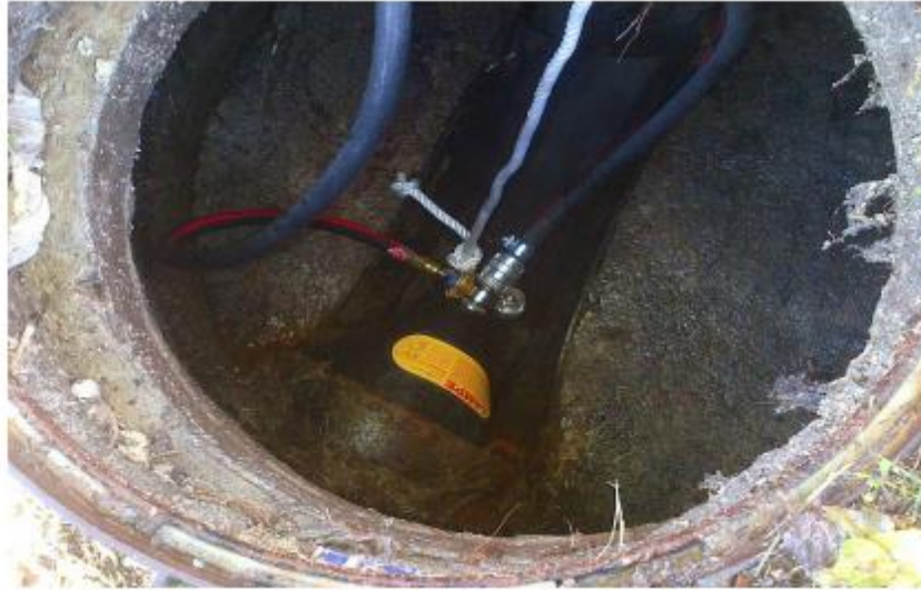
Figura 17 - Ensaio de estanquidade com recurso a ar e a água (Martins, 2015).
