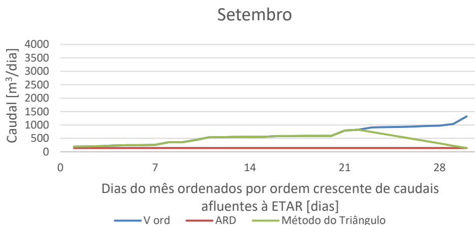
Figura 25 - Aplicação do método do triângulo para os caudais afluentes à ETAR do Ameal no mês de setembro.
