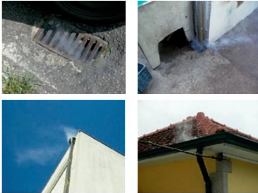
Figura 15 - Aplicação de testes de fumo (Almeida & Cardoso, 2010).
