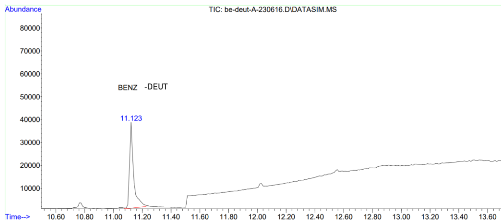
Figura 26. Cromatograma extraído para a benzoilecgonina-D3 com tempo de retenção de 11,1 min ( m/z=243 ).
