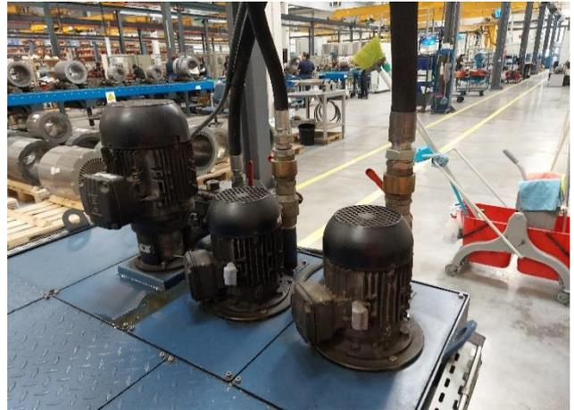
Figura 8 - motores 2kW e 4kW
