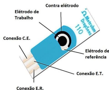
Fig. 5. Esquema dos constituintes de SPE comercial (adaptada da Metrohm DropSens).
