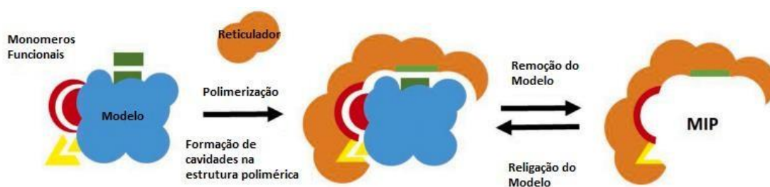
Fig. 4. Esquema dos vários passos para formação do PIM (adaptado de [18]).
