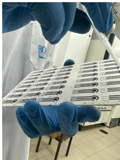
Fig. 14. Remoção dos resíduos com azoto.
