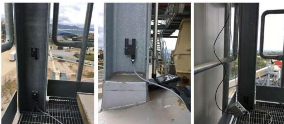
Fotografia 4.4 – Lado esquerdo: acelerómetro em P3; Meio: acelerómetro em P2; Lado direito; acelerómetro em P1 (Peres, 2019).
