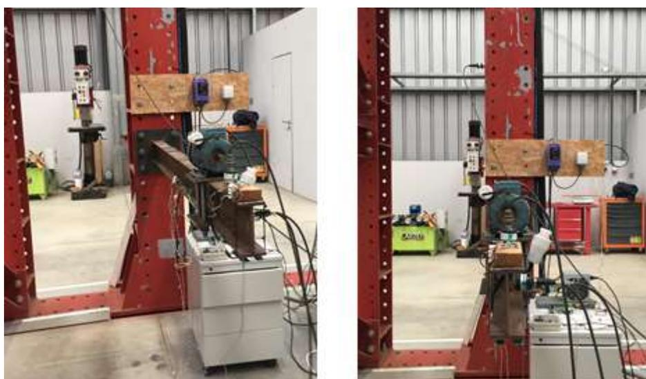
Fotografia 4.1 - Equipamento de teste e localização dos acelerómetros (Peres, 2019)
