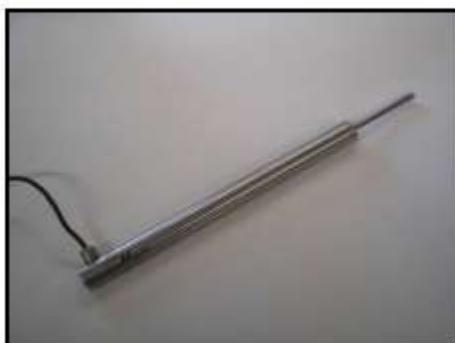
Figura 2.8 – Dispositivo LVDT (Cavadas, 2008).
