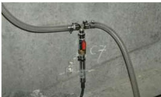
Figura 2.9 – Célula de pressão de um sistema de nivelamento hidrostático (Santos L. , 2014).
