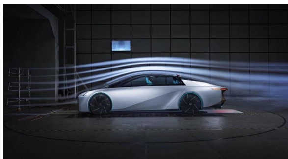
Figura 3.5 - Perturbação de um fluido (ar) por um objeto em movimento (carro). (Fonte: Razão Automóvel, 2019).
