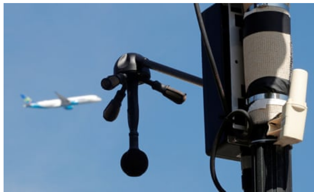
Figura 3.10 - Radar de ruído instalado em Villeneuve-le-Roi, perto do aeroporto Orly em Paris (Fonte: The Guardian, 2022).
