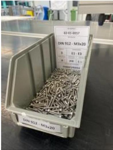
**Figura 4.3:** Caixa para fornecimento de material *Kanban*.
