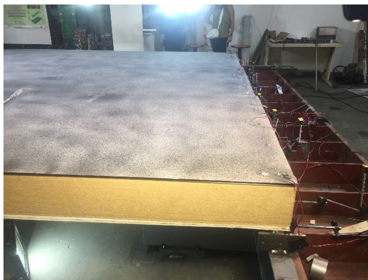
Figura 3.2.1 - Imagem real do painel de isolamento com lã de rocha em forma de sandwich.
