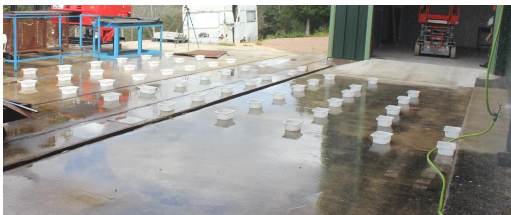
Figura 6.8. Ensaio de verificação da distribuição espacial da água aspergida.
