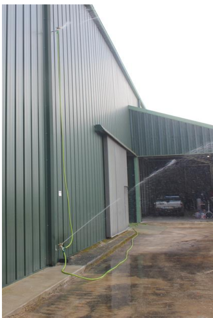
Figura 6.5. Ensaio de aspersão realizado no LEIF, Lousã.
