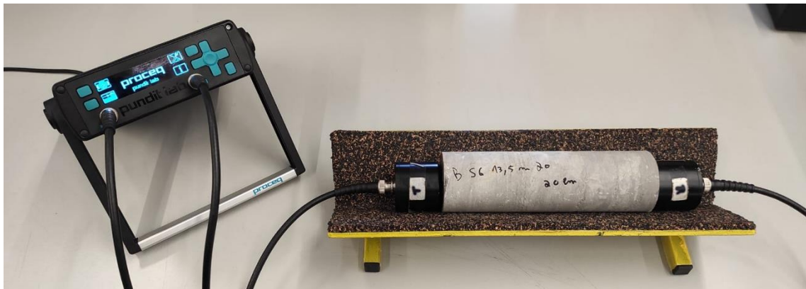
Figura 12 Provetes preparados para a realização do ensaio de Ultrassons, determinação da velocidade das ondas longitudinais.
