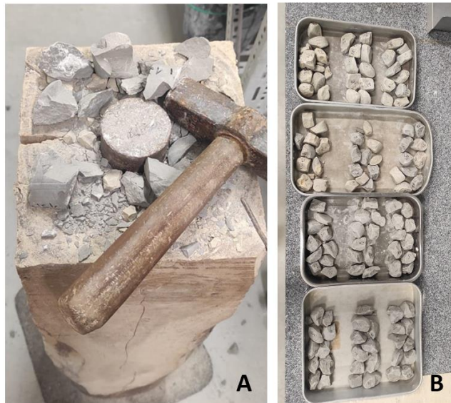
Figura 24 Slake Durability Test: A) processo de fragmentação do material; B) material fragmentado preparado.
