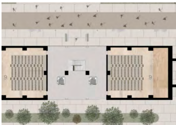
Figura 69. Planta do piso dos auditórios
