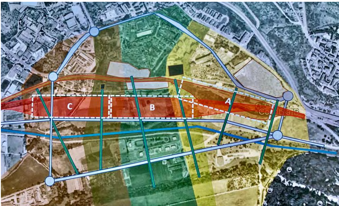
Figura 2. Sobreposição sobre fotografia aérea de esquema com as três hipóteses, propostas pelo Atelier de Projeto, para a implantação da nova estação ferroviária de Coimbra .
