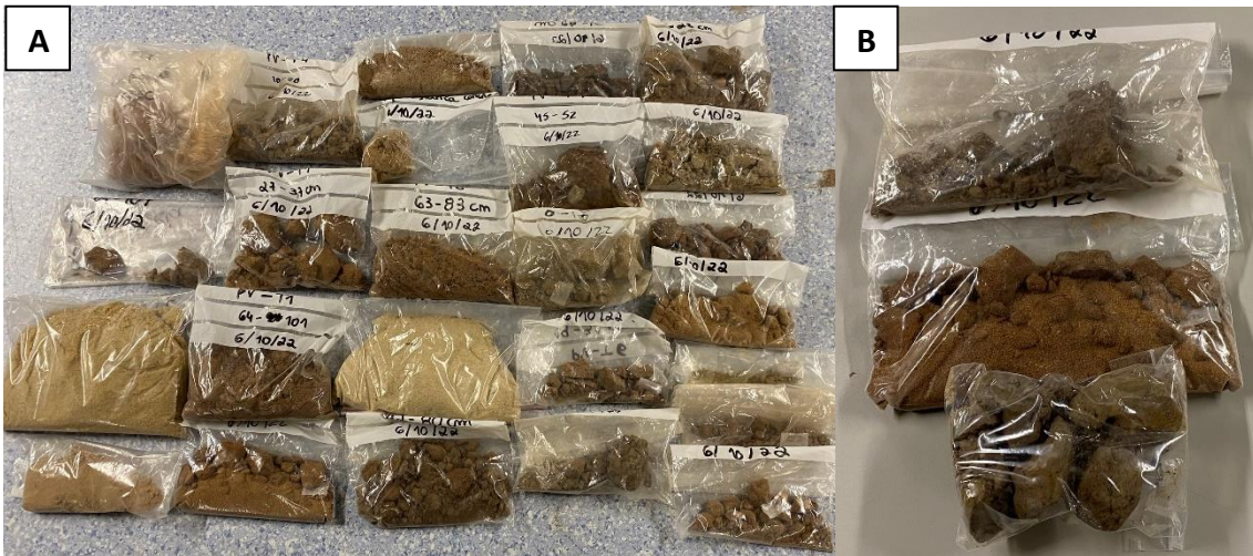
Figura 3.4 – A – Algumas das amostras recolhidas nas trincheiras dos potenciais depósitos de tsunami em Verde Lago, Algarve; B – Algumas das unidades estratigráficas encontradas nas trincheiras (de cima para baixo: solo eólico, areia com seixos e lodo castanho).
