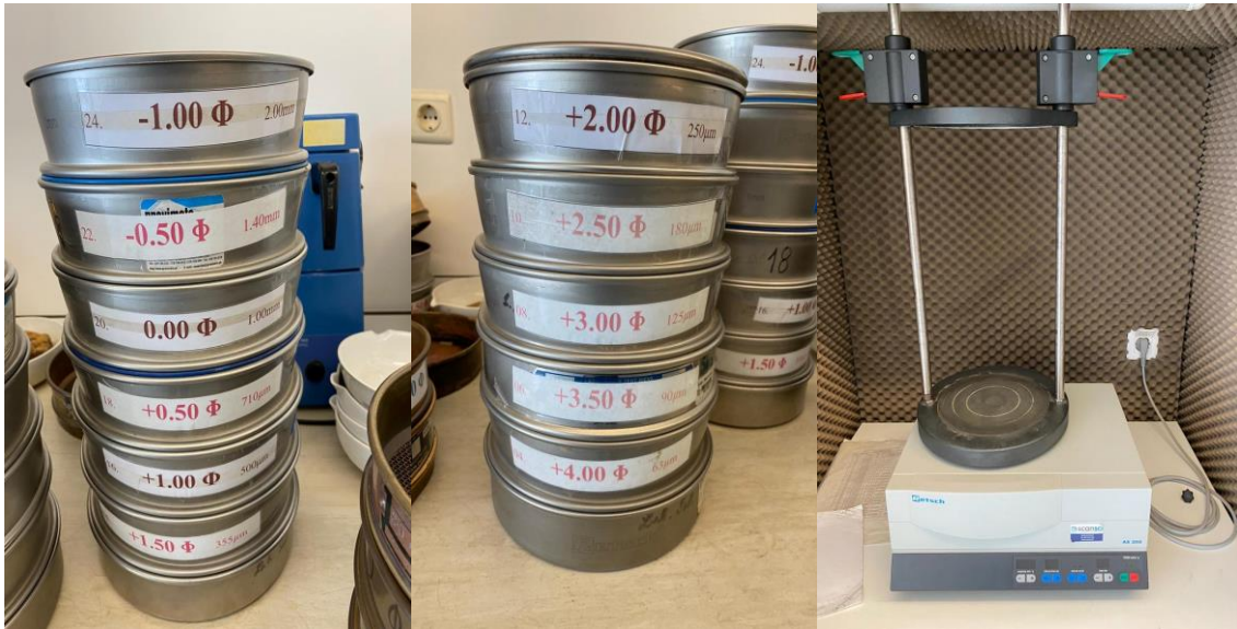
Figura 3.10 - Conjunto de crivos e agitador de crivos Retsch AS200 usadas para o tratamento das amostras recolhidas na campanha realizada em Verde Lago, Algarve.
