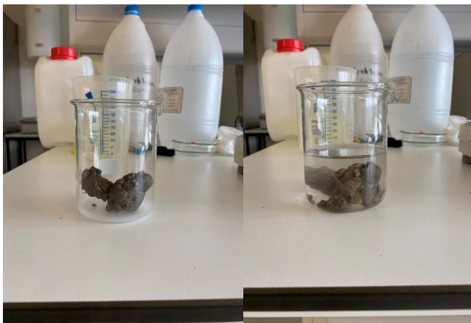
Figura 3.12 – A – amostra de lodo colocada dentro de um goblé; B – amostra de lodo submersa por água destilada para separar os conglomerados.
