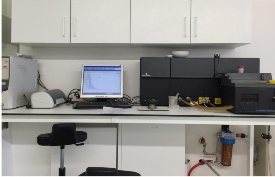
Figura 3.13 - Granulómetro laser marca Beckman-Coulter mod. LS230. Fonte: DCT website.
