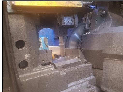
Figura 4.7 – Corte por disco abrasivo.
