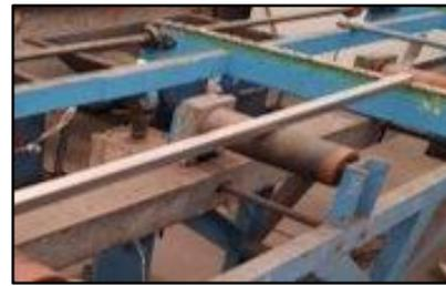
Figura 4.39 – Posicionamento da barra para o corte definido pelo caminho de rolos em CD 2.
