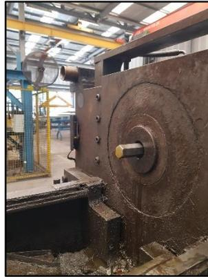
Figura 4.37 – Ponta “empurrada” ou extrudida no processo de estiragem.
