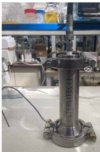
*Figura 27-Célula agitada Sterlitech HP4750.*
