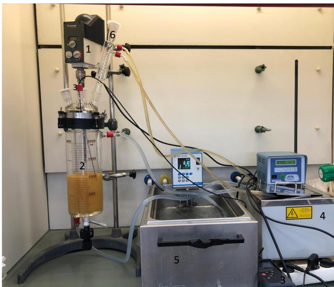
Figura 21- Montagem experimental para a reação de transesterificação.
