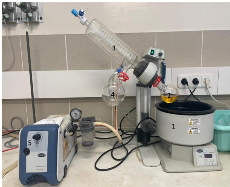
*Figura 26-Evaporador rotativo.*
