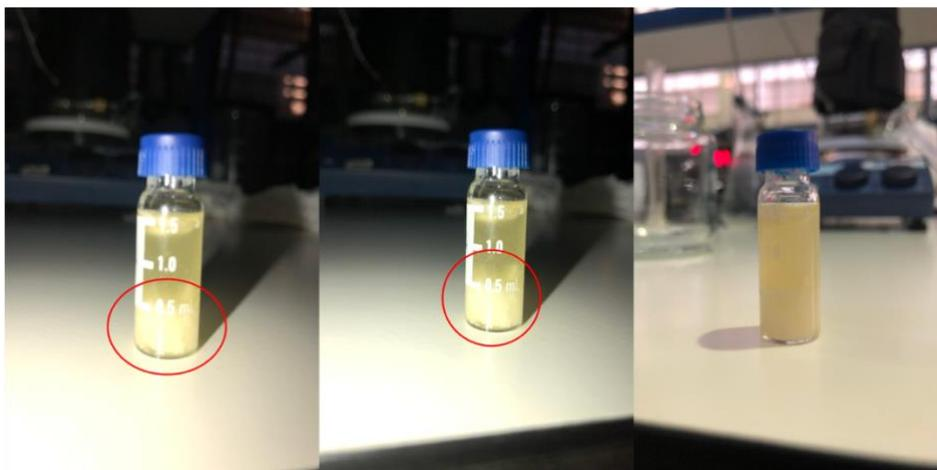
Figura 34-Biodiesel após purificação pela membrana de celulose regenerada.
