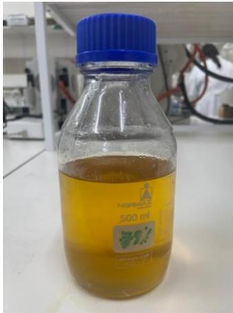
Figura 24- Biodiesel após purificação.
