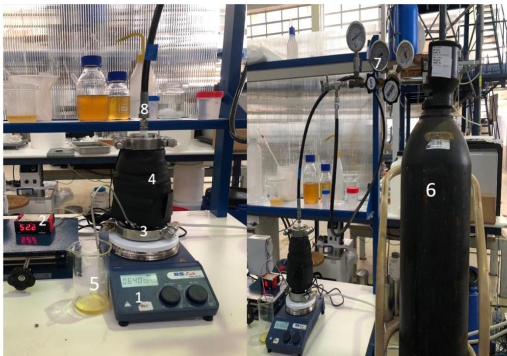
Figura 28- Sistema de Filtração com a célula agitada Sterlitech HP4750.
