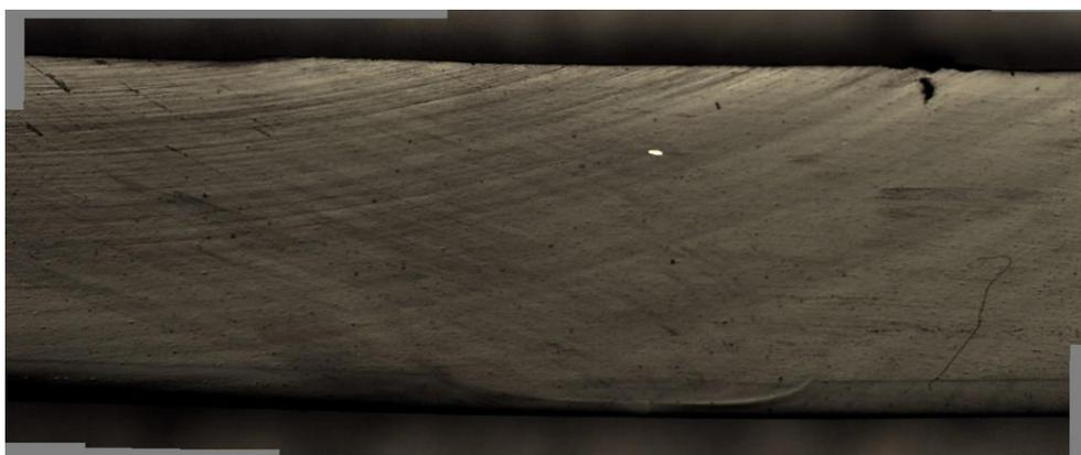
**Figura 58** Macrografia de corte longitudinal da soldadura ABSH02.
