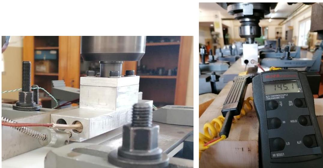
**Figura 5** a) Base estacionária com as resistências e termopar do controlador; b) Termopar Hanna.
