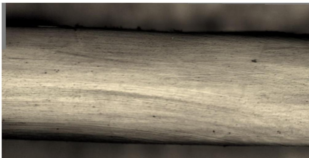
**Figura 60** Macrografia de corte longitudinal da soldadura ABSH06.
