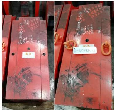
**Figura 3.43.** Guia antes e depois de colocar olhais e chapa de identificação.
