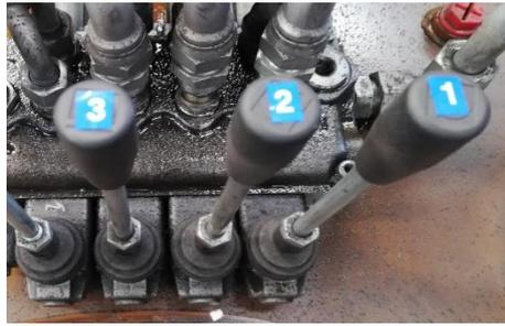
**Figura 3.41.** Etiqueta desenvolvida nas manetes da centralina hidráulica do robô.
