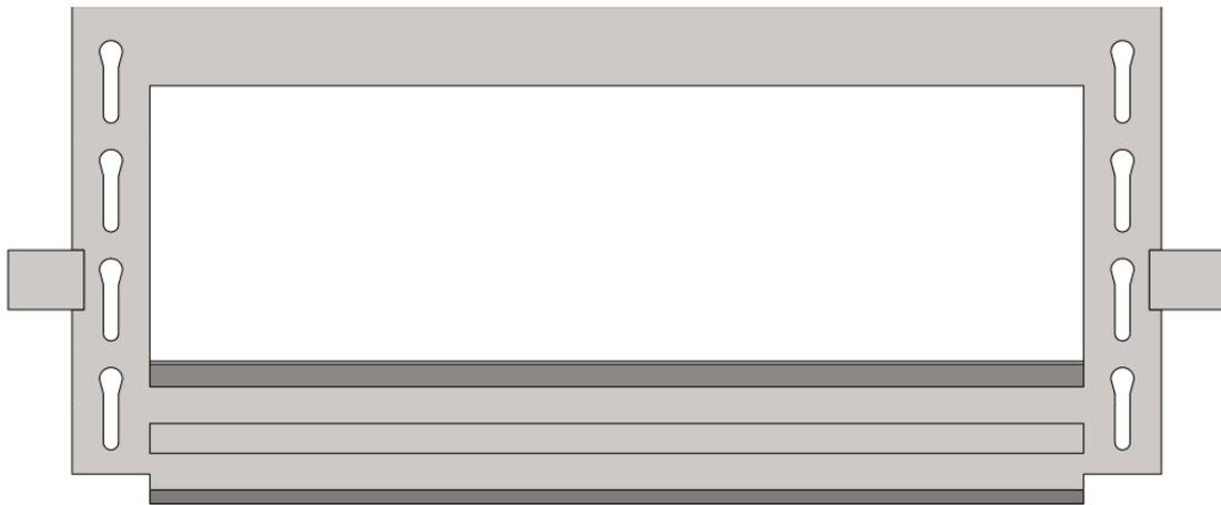
**Figura 3.26.** Desenho da travessa com rasgos maquinados.
