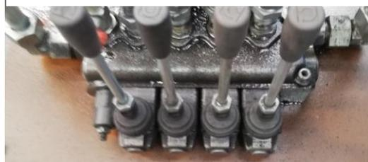
Figura 3.15. Manípulos para movimentação do robô.
