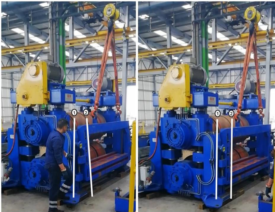
**Figura 3.16.** Travessa acoplada ao montante.
