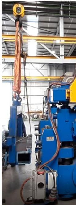
**Figura 3.42.** Diferencial colocado para nivelar a travessa.
