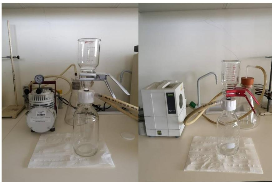
**Figura 8** – Filtração da amostra com o filtro de 0,45  $\mu\text{m}$  (esquerda) e com o filtro de 0,22  $\mu\text{m}$  (direita).
