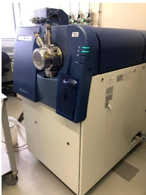
**Figura 10** – Cromatografia líquida de elevada resolução acoplada a detetor de massa com analisador por tempo de voo (INIAY).
