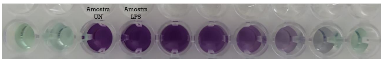
Figura 2 - Determinação da quantidade de proteína presente em EC pelo método do Ácido Bicinchonínico (BCA)
