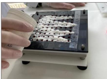
**Fig.1** - Enchimento das cápsulas de DEHA.
