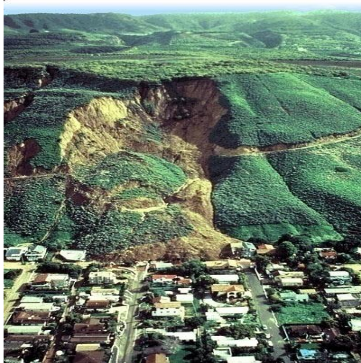
Figura 3.6 - Imagem que ilustra um deslizamento rotacional de La Conchita, Califórnia, Estados Unidos da América. Retirada de Higihland & Bobrowisky (2008).
