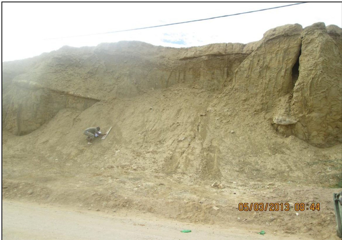
Figura 5.2 - Os tipos de instabilidades presente na área apresenta erosão diferencial, escarpa, descontinuidade.
