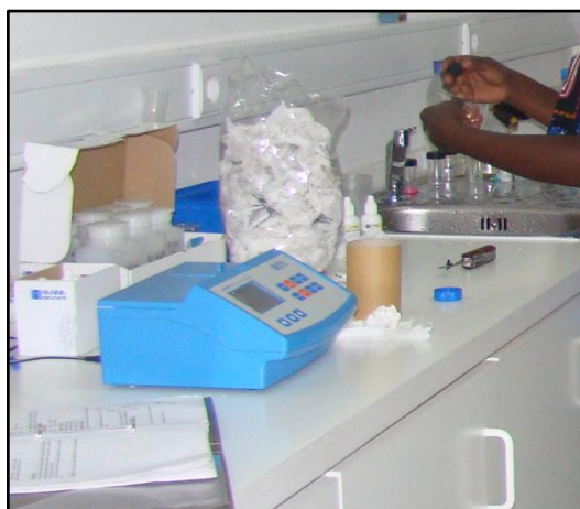
Figura 9- análise química com fotómetro de bancada de marca Hanna modelo HI83200
