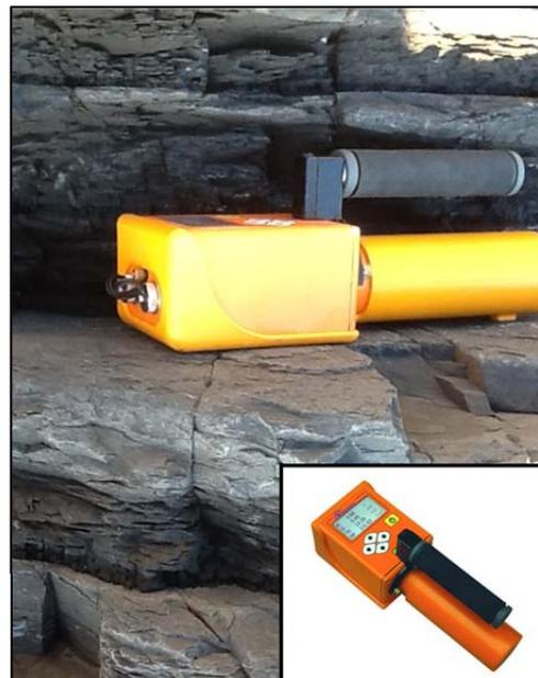
**Figura 3.1 – Aparelho medidor de radiação gama *Gamma Surveyor II*.**
