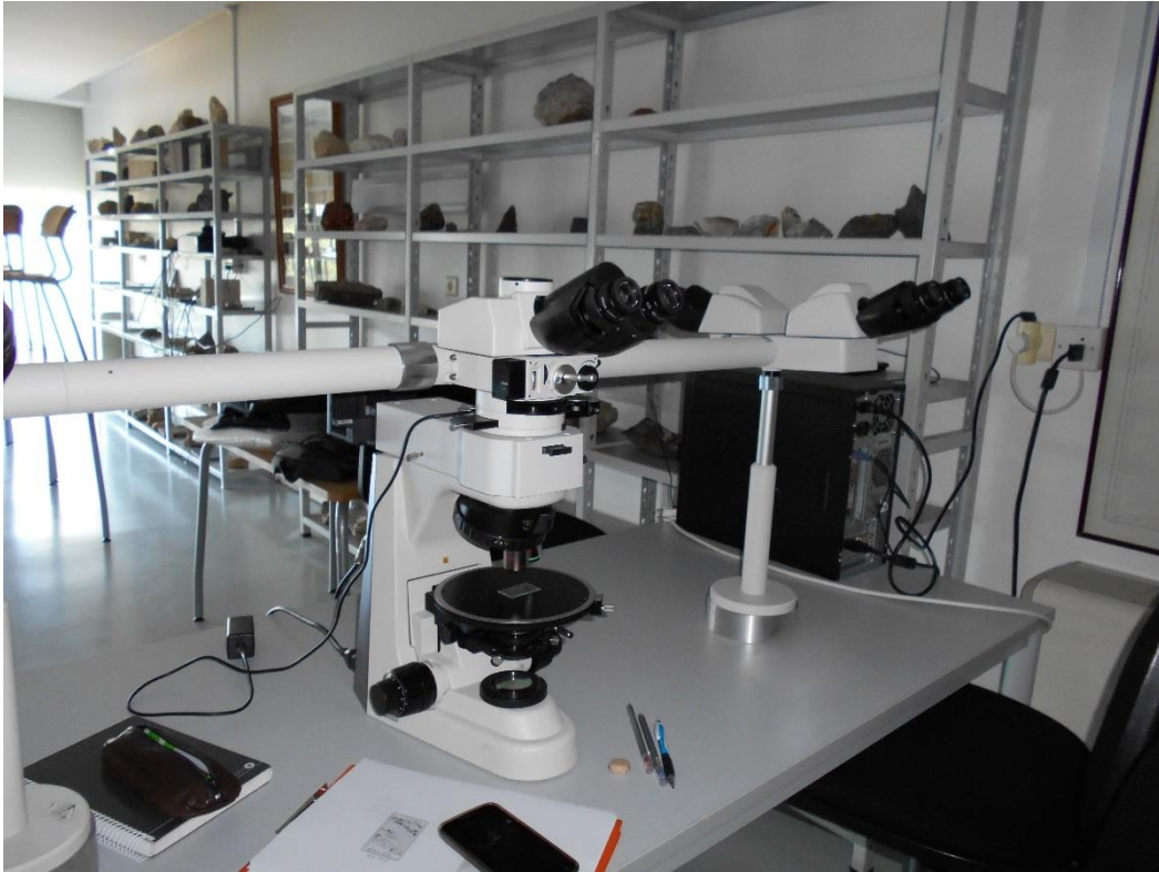
Figura 4.3. Microscópio de luz transmitida e refletida utilizado para a observação das lâminas polidas de Escádia Grande, no Departamento de Ciências da Terra da Universidade de Coimbra.
