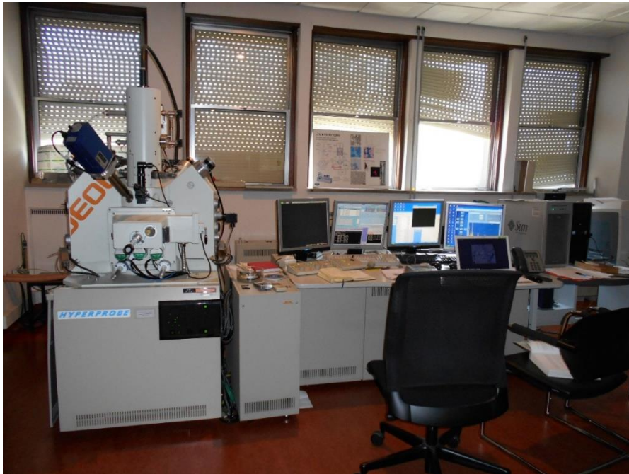
Figura 4.6. Microsonda eletrónica JEOL JXA-8500F do polo de S. Mamede de Infesta do Laboratório Nacional de Energia e Geologia.
