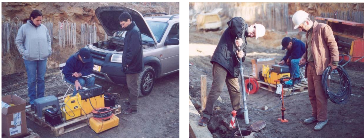
Figura 3.27 – Fotografia do equipamento do ensaio Cross-Hole (Viana da Fonseca em 08-03-2002)
