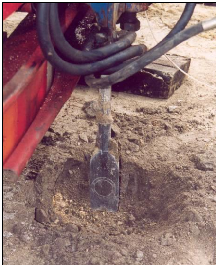
Figura 3.25 – Fotografia da lâmina do ensaio DMT (Viana da Fonseca em 07-03-2002)
