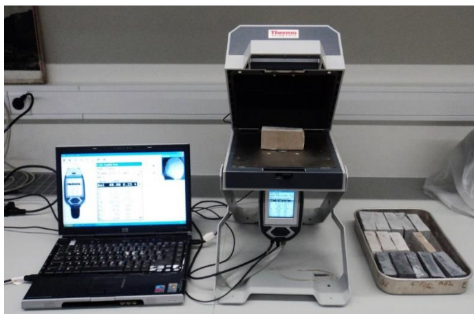
Figura 6.9 – Procedimento e equipamentos utilizados na determinação da composição química dos calcários em estudo.
