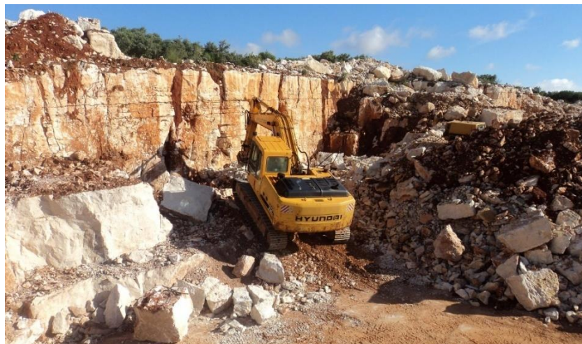
Figura 4.5 – Pedreira de pedra de calçada no Núcleo de Explorações de Porto de Mós – Alcanede, onde se pode observar a estratificação sub-horizontal do maciço calcário.
