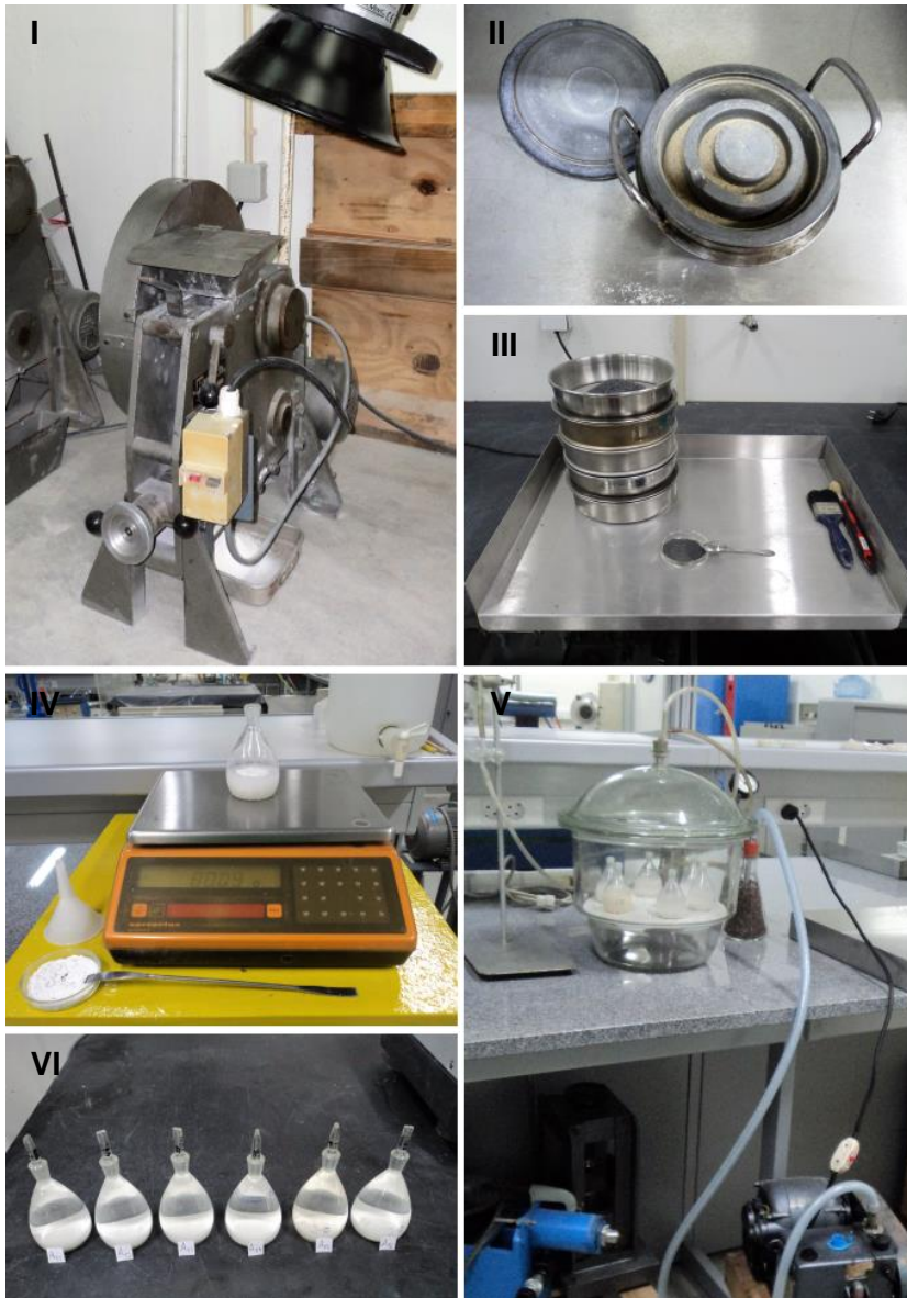
Figura 7.5 – Procedimento utilizado na determinação da massa volúmica real e da porosidade total: (I) redução da granulometria dos fragmentos dos provetes no britador de maxilas; (II) moagem dos provetes no moinho de anéis; (III) crivagem do pó a uma granulometria inferior a 0,063 mm; (IV) colocação e pesagem do pó no picnómetro; (V) picnómetros sob vácuo para a retirada completa do ar; (VI) picnómetros em repouso para que o material assente e a água fique límpida para depois ser colocada de nível.
