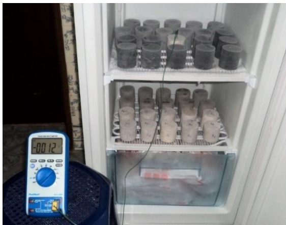
Figura 7.17 – Disposição dos provetes dentro do congelador onde se procedia ao controlo da temperatura de congelação.
