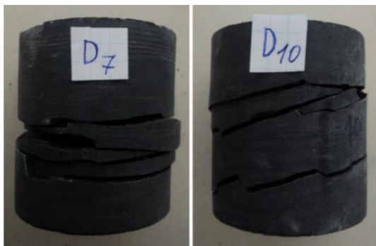
Figura 7.20 – Provetes do calcário D (D 7 e D 10 ) que se partiram por grandes fracturas.
