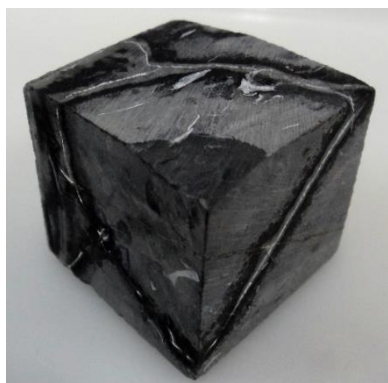
Figura 7.15 – Provete onde é evidente o preenchimento das descontinuidades por cristais de sulfato de sódio.
