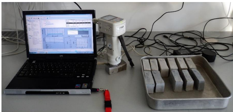
Figura 6.5 – Procedimento e equipamento utilizado na caracterização colorimétrica dos calcários em estudo.
