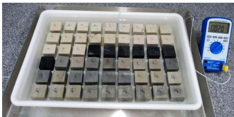
Figura 7.14 – Embebição dos provetes na solução salina onde se encontravam com um afastamento entre si de pelo menos 10 mm e 20 mm relativamente às paredes do recipiente e com o nível da solução a situar-se cerca de 8 mm acima do seu topo. Neste procedimento também se utilizou um multímetro para controlo da temperatura da solução.
