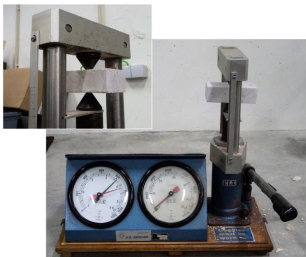
Figura 7.2 – Equipamento utilizado na realização do ensaio de resistência à carga pontual.
