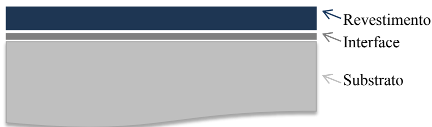
Figura 7. Zonas de um sistema tribológico substrato/revestimento [3].
