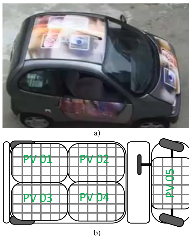
Figura 4.11. a) Vista de cima do protótipo; b) Esquema de implementação da matriz de painéis.
