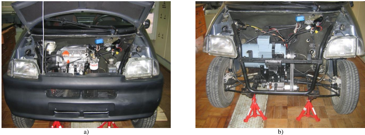
Figura 2.7. Ligier 162 GL a) Motorização original – Motor de combustão interna LOMBARDINI; b) Adaptação do motor assíncrono trifásico – DV112M4 da SEW-Eurodrive.
