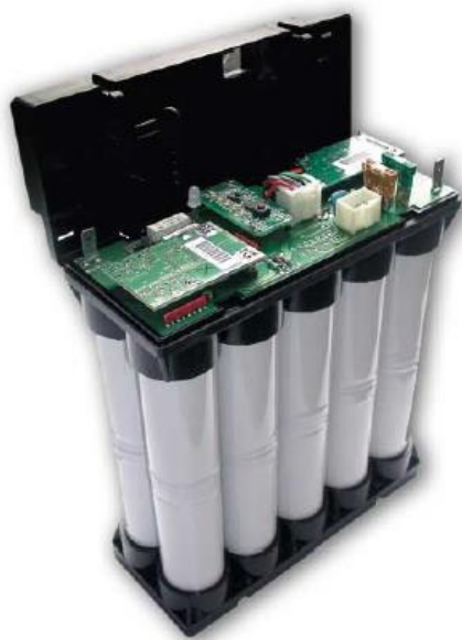
Figura 2.8. Fotografia da uma bateria designada por Super High Energy Ni-MH battery module da SAFT.
