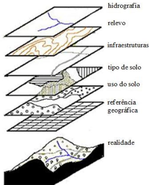
**Figura 6: Exemplo da definição de uma superfície em níveis de informação.**
