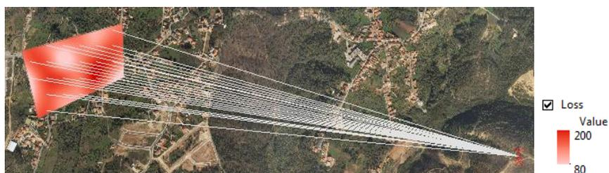
**Figura 30: Exemplo de representação das perdas de uma configuração 1xArea no ArcGIS.**
