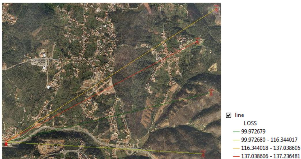
**Figura 29: Exemplo de representação das perdas de uma configuração Mx1 no ArcGIS.**
