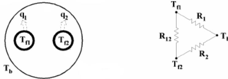
**Figura 3.6.** Secção de corte de uma sonda geotérmica vertical, e o correspondente  $\Delta$  – Circuito térmico segundo Hellström (1991) (Young, 2004).
