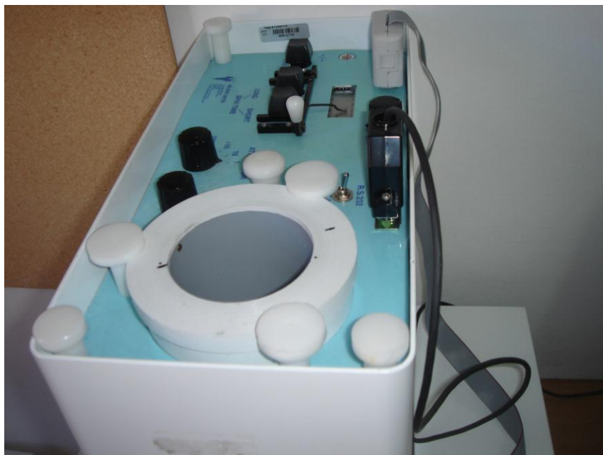
Figura 3 – Magnetómetro rotativo Molspin . (Departamento de Ciências da Terra da Universidade de Coimbra).
