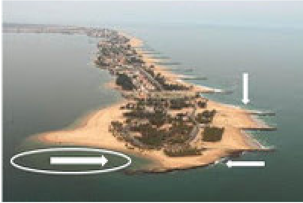
Fig. 4.25- Locais de mais intensa erosão na cabeça da restinga do Lobito, assinaladas com setas e o círculo brancos. Imagem base de GoogleEarth, disponível em http://nunovrsantos.blogspot.pt/2009/07/ao-longo-dos-ultimos-anos-tem-se.html , acedida em 26/09/2012.)
