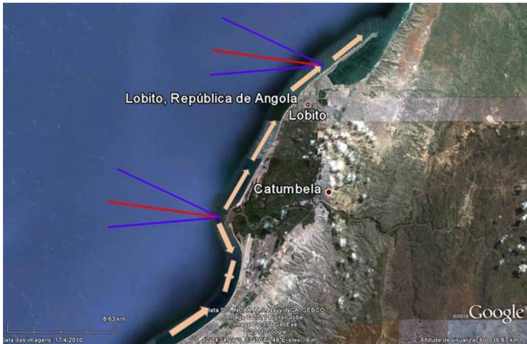
Fig. 4.14- Direcção da corrente de deriva litoral esperada a norte e sul da embocadura do Catumbela em resposta aos rumos de ondulação apresentados em Abecassis (1958). A azul os limites do intervalo de rumos observados (azimutes entre 265º e 295º), com moda de cerca de 278º a vermelho (Silva, 2011).
