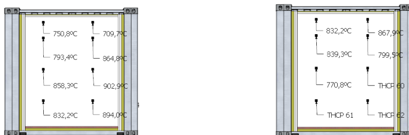
Figura 3.9 e 3.10 – Temperaturas máximas da modelação experimental da parede 2 e 4, no ensaio 2, respetivamente.
